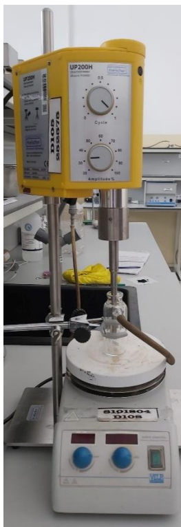
Figura V.7 Echipament UAE: aparat sonicare Hielscher UP200H, reactor cu manta, plită electrică cu unitate de control a temperaturii și agitare magnetică
